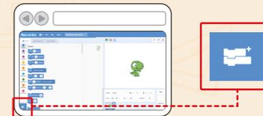
Після входу в інтерфейс програмування клацніть піктограму в нижньому лівому куті, щоб отримати доступ до сторінки вибору пристроїв
