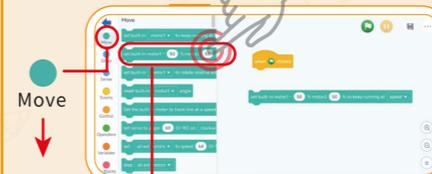
Автомобіль має почати рух, тому йому потрібно знайти модуль керування двигуном із області модуля Motion.
